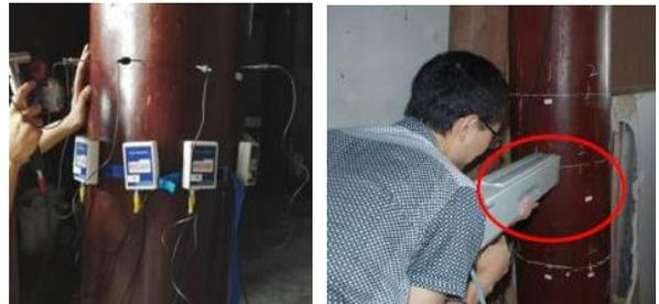
西湖十景之一“平湖秋月”检测项目借助应力波技术和微钻阻力技术对御书楼立柱、横梁等构件进行检测。
