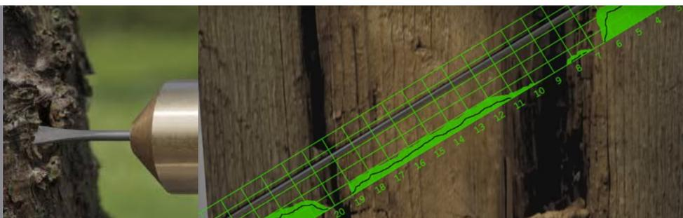
在电动机驱动下，仪器的微型钻针以恒定速度钻入树木内部，产生相对阻力，阻力的大小反应出木质密度的变化，已有很多实验证实木质密度和微钻阻力之间有显著的统计学上线性关系，微钻阻力越大，则密度越大，表示木质健康，否则，木质有损伤；微机系统采集钻针在木质中产生的阻力参数，在软件上将数据可视化显示。
