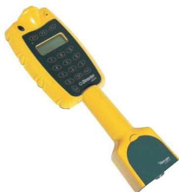
HM220 原木品质测量仪提供直接的方式来测量原木或木材的紧实度，无损害的快速检测原木的内部品质。利用声音在原木和木材中的传播速度，评估木材的紧实度，确定木质的好坏，方便的对其进行分级。用于木材加工、造纸选材，快速分级木材等。
