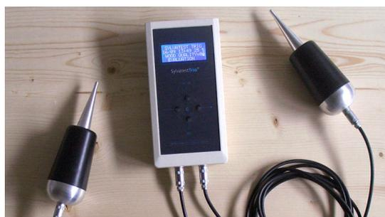
Sylvatest TRI0 超声波木材检测仪是 Sylvatest 系列的第三代重大革新设备，用于评估立木内部构造的木材腐蚀程度和剩余物理状态。
